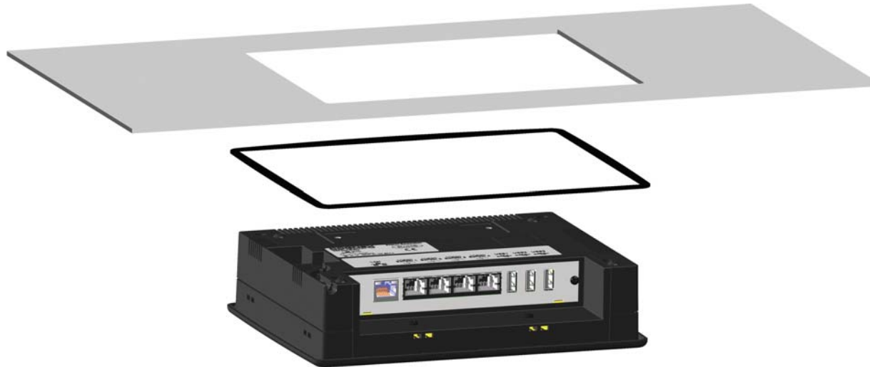
Figura 2-1: Guarnizione in gomma e pannello
