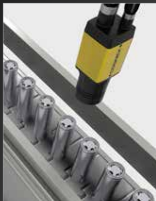
Inspection de la surface de cellules de batterie de voiture électrique
