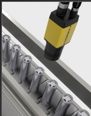
EV 电池检测
